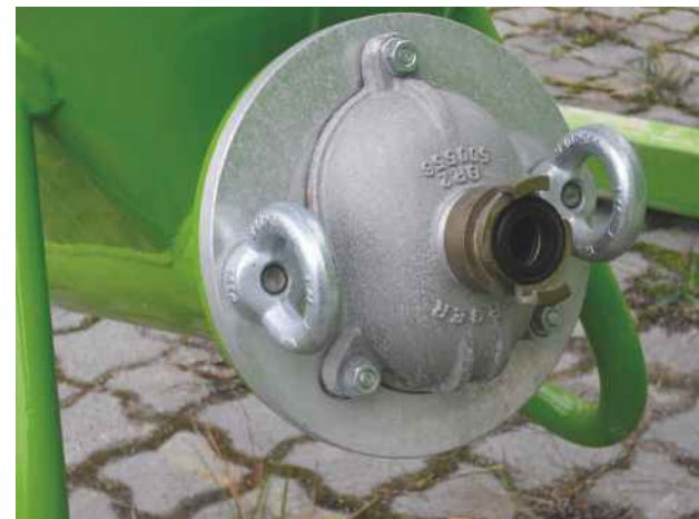
Multi-Förderdüse der Berger - Förderanlage
